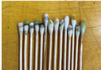
소금물을 묻힌 면봉과 접촉된 부위의 색이 변한 모습  $\text{Fe}(\text{OH})_2$ 로 인해 검게 변한 소금물을 묻힌 면봉
