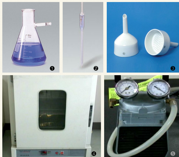
〈그림 2〉 ① 감압 플라스크(chemlab), ② 홀피펫(chemlab), ③ 뷰흐너 깔때기(chemlab), ④ 오븐(chemlab), ⑤ 진공펌프(chemlab)
