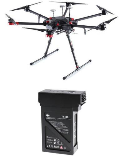
〈그림 4〉 DJI사 Matrice 600 Pro 드론과 이에 사용되는 TB48S 리튬 폴리머 배터리 시스템
