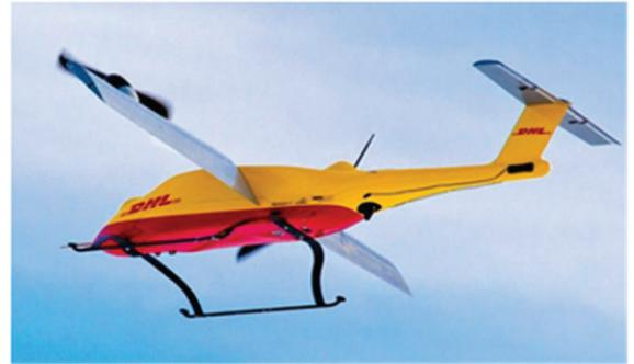
〈그림 10〉 DHL 사 택배 드론, 쿼드콥터 수직이착륙 저속 이동형에 틸트 주날개를 부착하여 수직이착륙 고속 이동형 제품으로 전환 중
