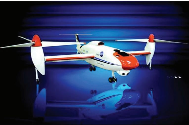
〈그림 12〉 한국항공우주연구원 개발한 수직이착륙 고속이동 틸트로터 드론 "스마트 UAV"
