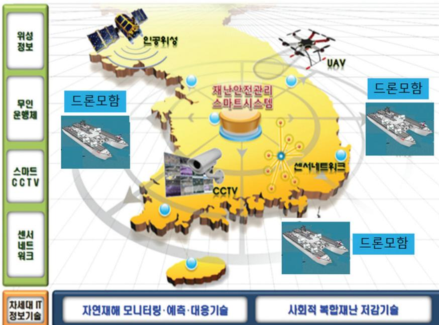
〈그림 15〉 드론 모함(Drone Carrier)에서 다수의 공중 드론과 수중 드론이 운용되며 임무 수행을 할 수 있는 복합드론(C-Drone) 개념도
