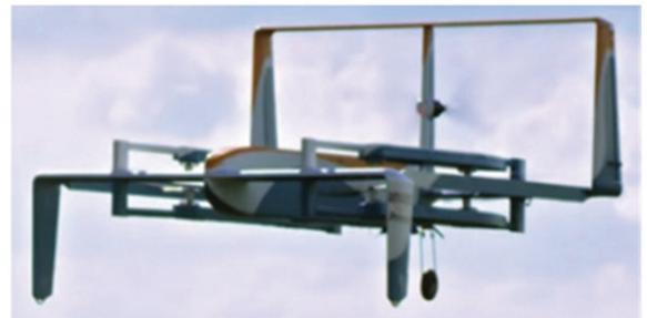
〈그림 9〉 아마존 사 택배 드론, 쿼드콥터 수직이착륙 저속 이동형에 틸트 주날개를 부착하여 수직이착륙 고속 이동형 제품으로 전환 중
