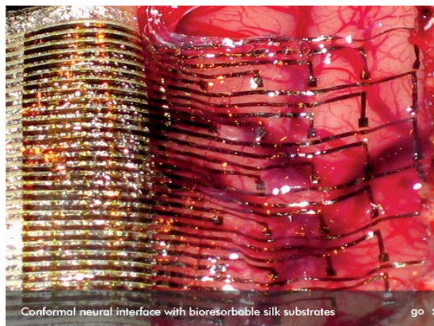
김대형 교수님의 플렉서블 일렉트로닉스 연구실에서 연구중인 conformal neural interface with bioresorbable silk substrates – http://flextronics.snu.ac.kr/
