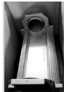
미세먼지를 거르는 필터. 피러 중앙의 움푹 파인 곳에 빗물이 고이면 먼지는 아래로 가라앉고 맑은 물만 옆으로 빠져나가는 원리다.
