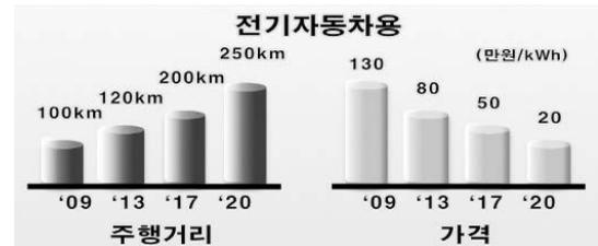
(그림 7) 우리나라 전기차용 배터리 개발 로드맵
