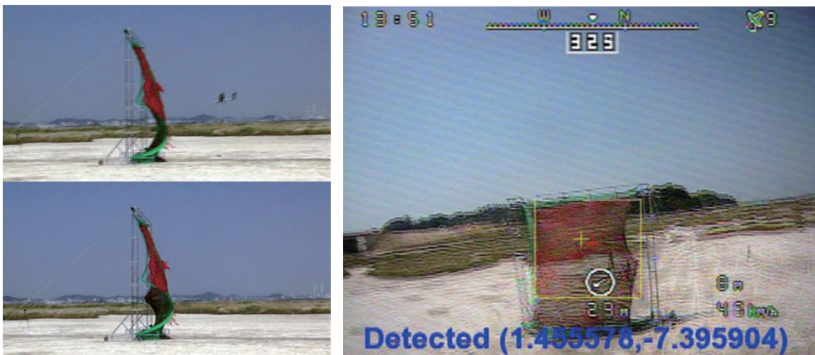
그림 4. 영상정보를 이용한 자동착륙 비행시험 (좌: 착륙과정, 우: 탑재 카메라 영상)
