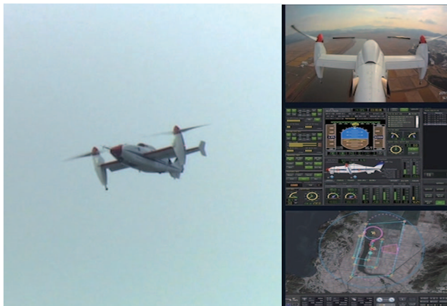
그림 3. 스마트 무인기 30도 틸트 천이비행 시험 장면: 지상 카메라 영상(좌), 미크 탑재 카메라 영상(우상), 지상 관제장비(우중), 임무비행 궤적 영상(우하)
