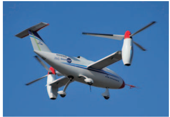
그림 5. 국내 민군 활용 및 해외시장 개척을 위해 실용화를 추진 중인 200kg급 틸트로터 무인기, TR60
