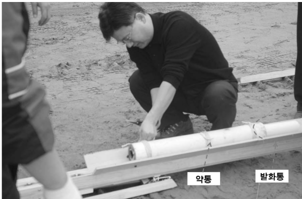
〈그림 7〉 허환일 교수가 대신기전 약통과 발화통을 안정막대와 연결중인 모습
