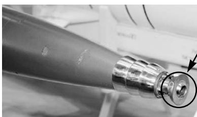
cavitator가 있는 Shkval 전방부
