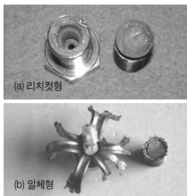
〈그림 5〉 폭발볼트 시험 후 분리형상
